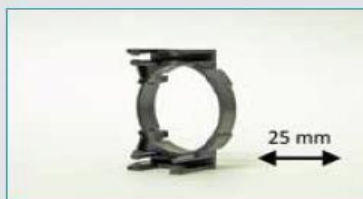
Spritzgussbauteil mit komplexen innenliegenden Strukturen
