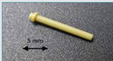
Kunststoffbauteil mit Hinterschnitten
