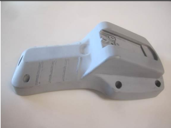
Oberfläche mit Haftvermittler und Füller lackiert sowie fein geschliffen
