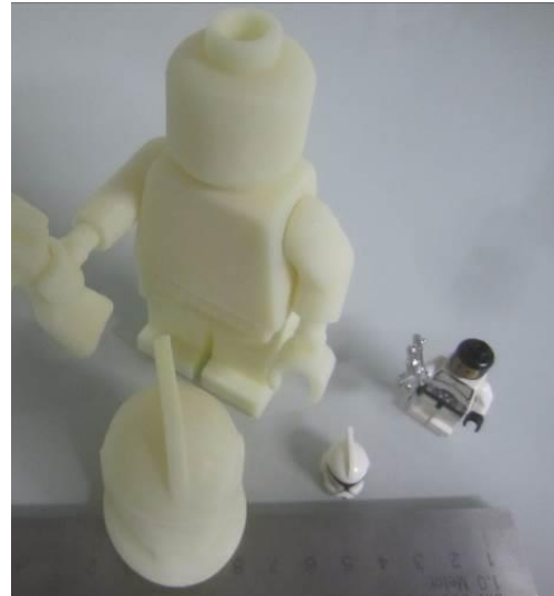
Im Massstab 3:1 mit FDM Printer gefertigt
