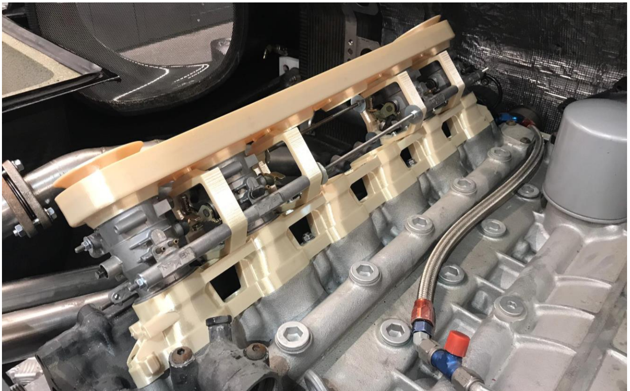
Zusammenbau der FDM 3D Druck F1 Motoren Luftansaugbauteile in der Werkstatt
