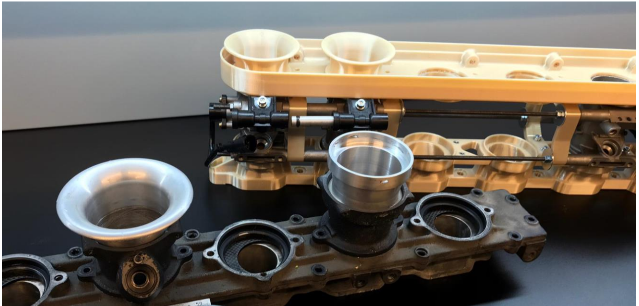
Zusammenbau der FDM 3D Druck F1 Motoren Luftansaugbauteile in der Werkstatt
