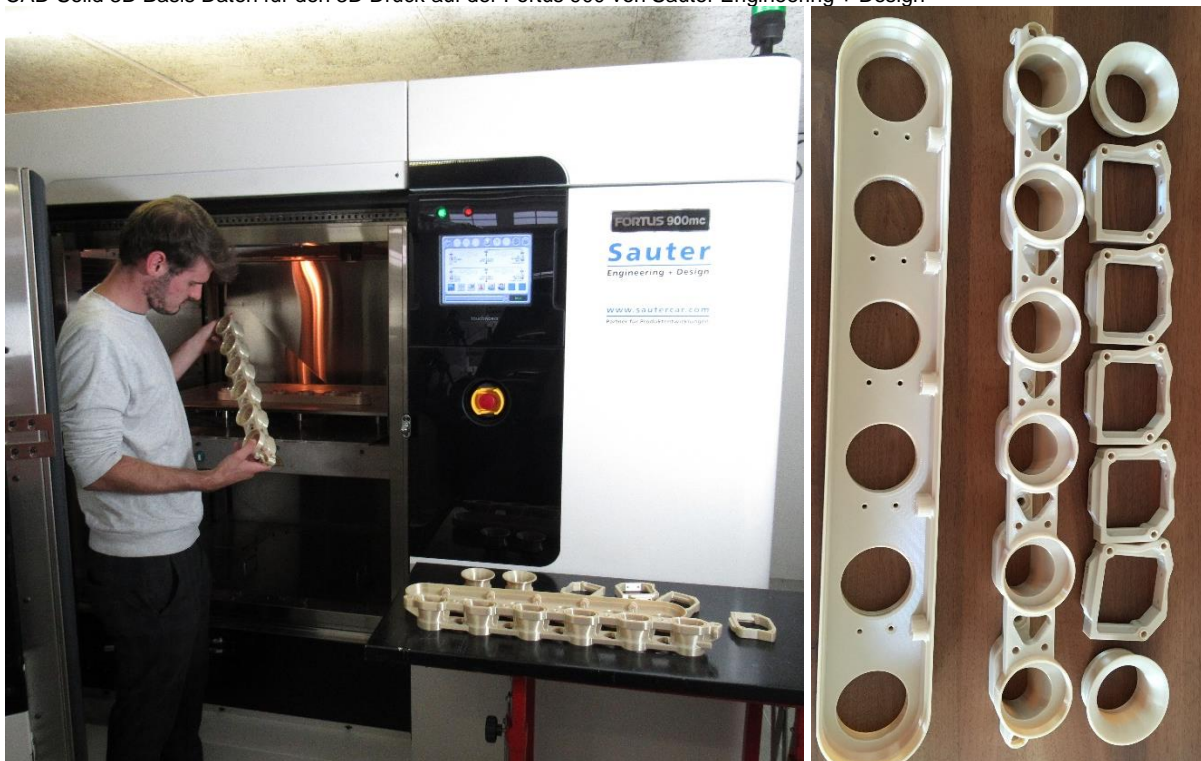
Stratasys F900 verfügt über den grössten Bauraum aller FDM-Produktionssysteme
