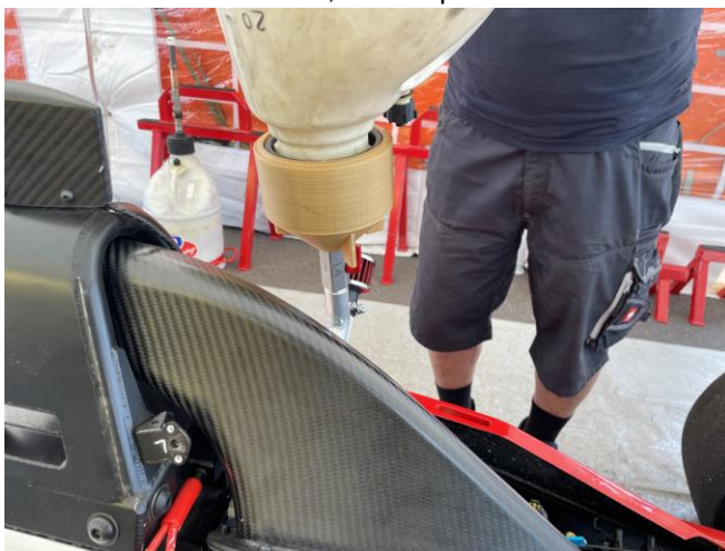
Erfolgreiche Betankung mit dem ULTEM 1010 Adapter
