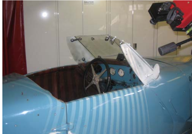
4. Präzise 3D Oberflächendigitalisierung mittels GOM ATOS System unter 0,028mm genau
