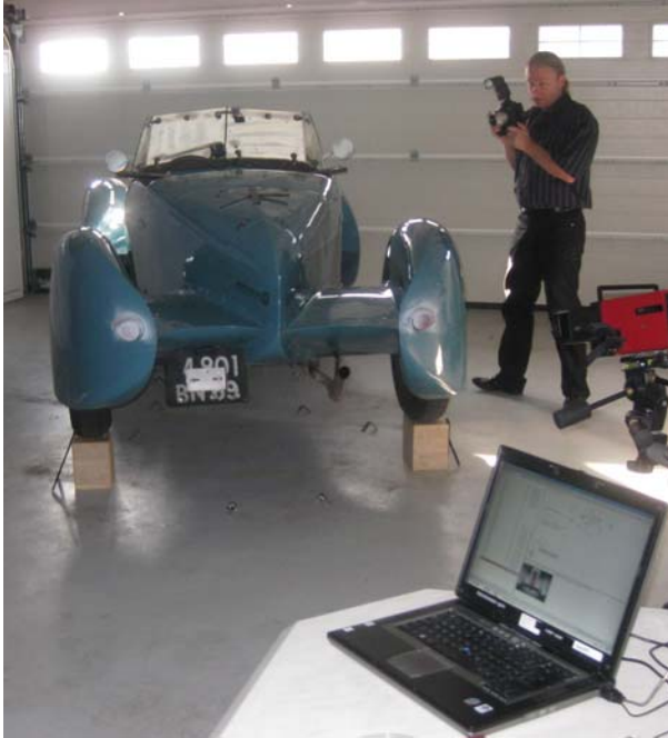
4. Präzise 3D Oberflächendigitalisierung mittels GOM ATOS System unter 0,028mm genau
