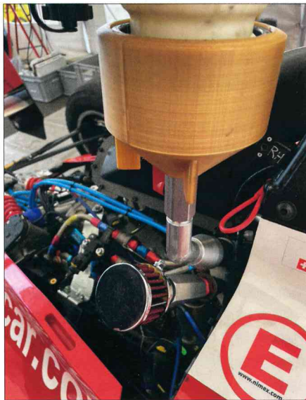
Das Engineering Team konstruierte einen Überwurf-Adapter zur Versteifung der Verschlusskappe. (Bilder: Sauter)
